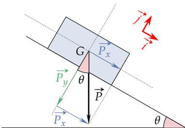
prenons un pavé qui glisse le long d'un plan incliné d'un angle  $\theta$  par rapport à l'horizontale. Pour étudier le mouvement du solide, il est assez naturel de choisir une base liée à ce plan incliné, ici il s'agit de la base  $(\vec{i}, \vec{j})$ .
